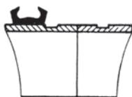
Per i tubi aventi un DN di 10" ed oltre, l'installazione può risultare facilitata rivoltando la guarnizione, stendendo un velo di grasso e facendo poi scivolare la guarnizione sul tubo, come illustrato in figura.
