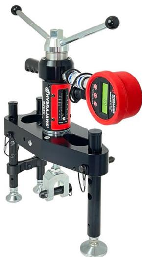
**Prosystem Italia** è in grado di erogare il servizio di prove non distruttive di estrazione ancoranti fino a 50kN.
